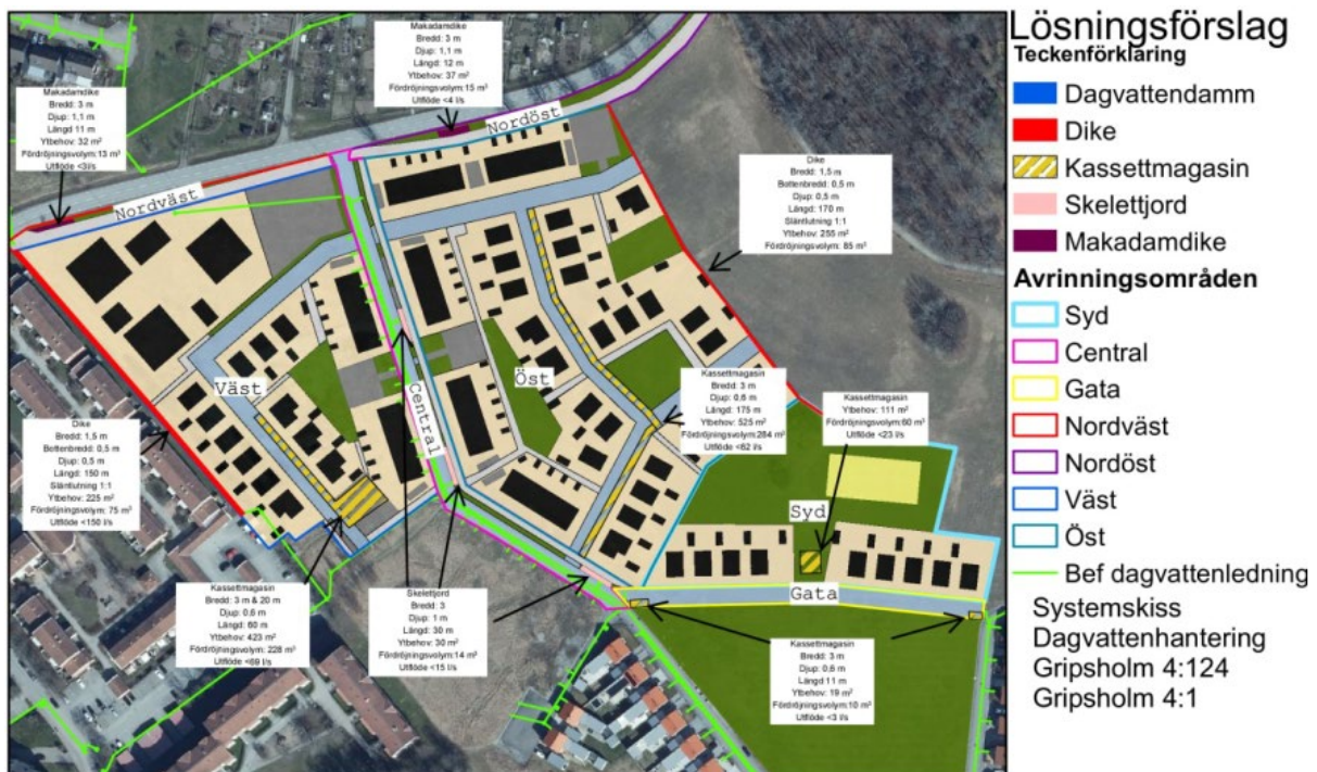
Förslag på lösningar för hantering av dagvatten inom planområdet.
