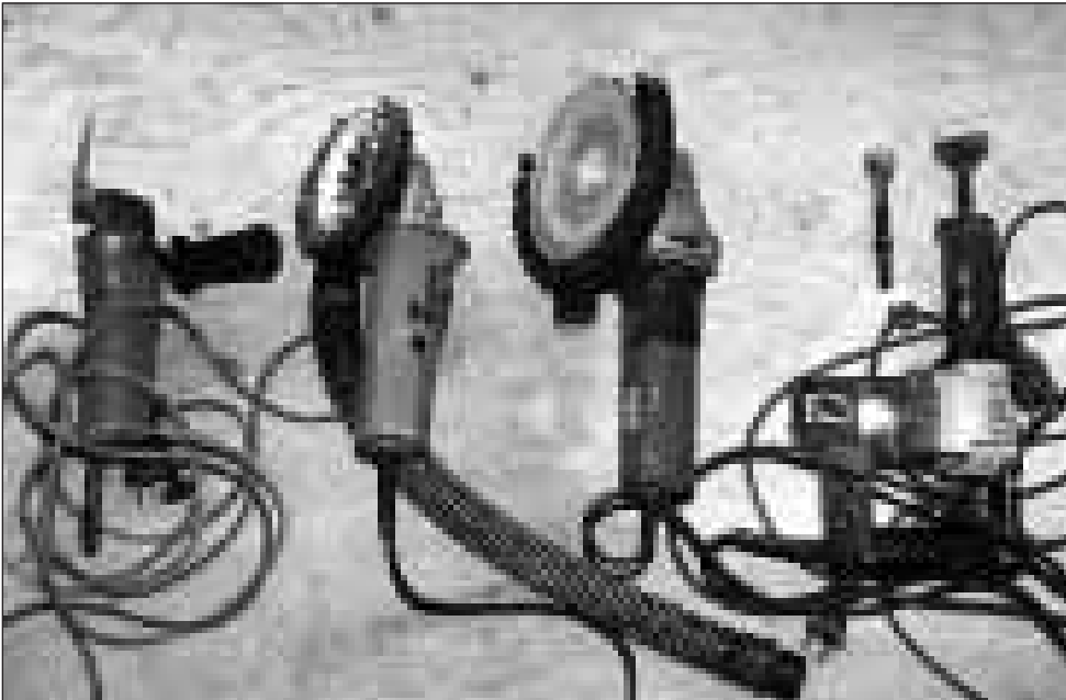
Figur 21. Olika verktyg har utvecklats för olika moment vid borttagning av fog i projektet "PCB-Fria Fogar". Från vänster till höger: vibrerande kniv, två slipverktyg och tryckluftsdreven mejsel.
