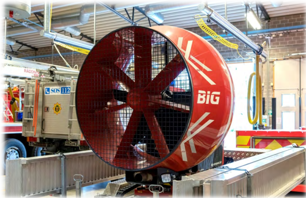
Bild: Mobil fläkt för evakuering av brandgaser i tunnel
